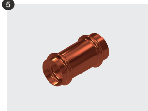
Skydemuffe Mål: ø 12 mm Materiale: Kobber Vægt: 50 g/stk.
