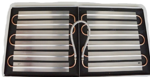
Figur 3: 2 stk. WLTD mm elementer forbundet med fleksible forbindelse med lynkoblinger monteret på WLTD elementes rørende. Bemærk fleksible slange må ikke være udstrakt.
