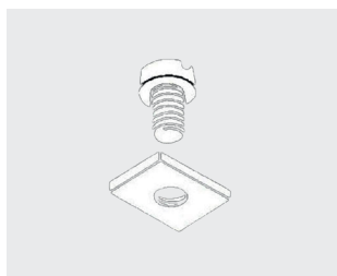
Møtrik og bolt Mål: Møtrik; 12 x 16 M6-gevind bolt; M6 x 8 Materiale: galvaniseret stål
